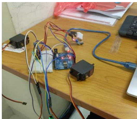
Gambar 16 Pengujian sensor dan servo dengan otak Arduino UNO
